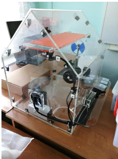
Настольная модель теплицы с датчиками окружающей среды
